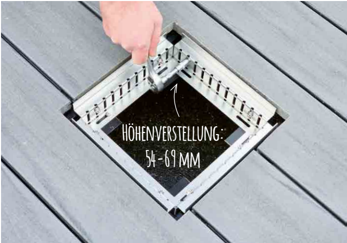
Höhe des Revisionskastens an den Terrassenbelag anpassen.
