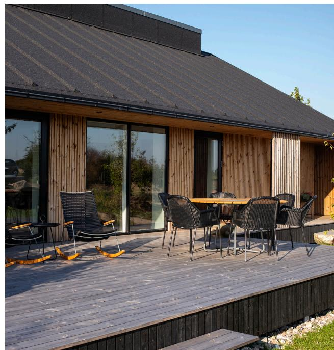
Frøslev ThermoWood® ist thermisch behandelte Kiefer mit guter Haltbarkeit und Formstabilität. Die Behandlung ist chemikalienfrei und verbessert die Eigenschaften des Holzes. Das Holz wird formstabilisiert und wird in die Resistenzklasse 2 eingestuft. Bei dieser Wärmebehandlung wird das Holz in unserer ThermoWood-Anlage auf eine Temperatur von über 200 Grad erhitzt und Wasserdampf hinzugefügt. Dabei ändert
